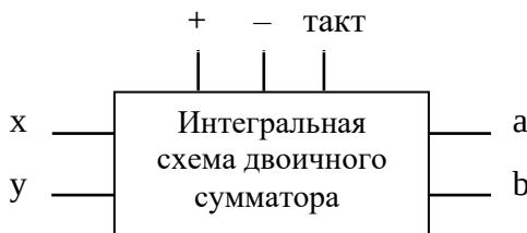
Рис. 2.2. б). Пример ИС двоичного сумматора.
